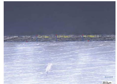
図4 「エステコート」の被膜厚さマイクロスコブ像。塗り方によって多少の誤差が想定されるが、基本的にはごく薄い被膜として形成される。
