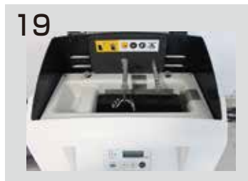
サンドブラスト後、エルトロポル300(BEGO 電解研磨器)を使用する。この器械は電気抵抗を自動で計測し各フレームに適したプログラムで研磨出来る優れた物で、同時に2個のフレームを研磨可能な点が特徴である。電解研磨液はワイロリット(BEGO)が推奨である。
