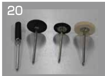
電解研磨後、左から1-2番目のラバーポリッシャーにて中研磨を行う。その後、レースにて研磨ペースト(BEGO・コバルトクロム合金用研磨ペーストブルー)を使用する。細かい部分はロビンソンブラシやフェルトポイントなどを使用し仕上げ研磨を行う。
