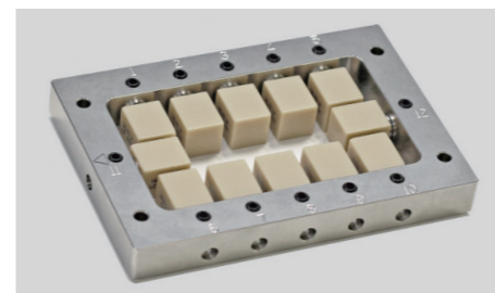
最大12個のブロックを 一度に切削可能
